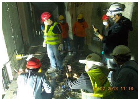
งานทดสอบแรงดึงเหล็กเสริม Utility Slab
