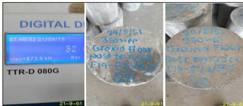
ทดสอบแท่นตัวอย่างพื้น Post ชั้น G อายุ 7 วัน CC1.2
