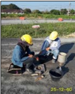
ทดสอบความแน่นของการบดอัดถนน CC1/1
