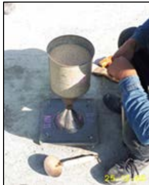
ทดสอบความแน่นของการบดอัดถนน CC1/1
