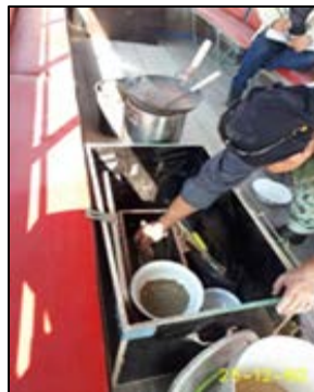
ทดสอบความแน่นของการบดอัดถนน CC1/1
