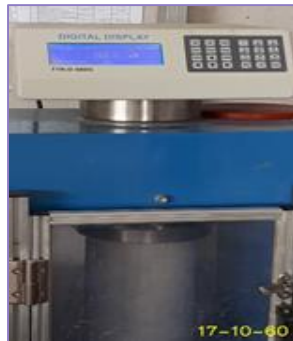
ทดสอบแท่นคอนกรีต PQC, CTB ( STN, SAT-1)
